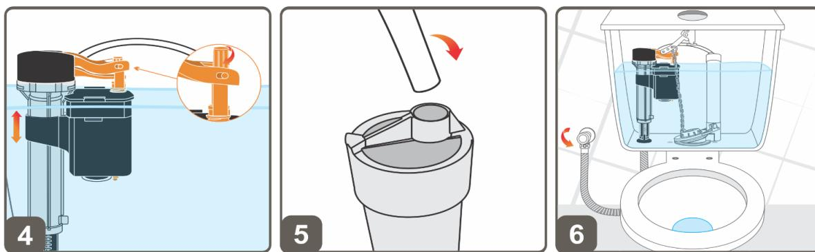
Ajuste o controle de volume de água dentro da caixa, girando a haste para o lado direito para descargas com menor volume de água e esquerdo para com maior volume.
