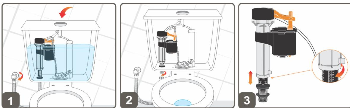
Feche o registro de alimentação da caixa de descarga ou registro geral da rede hidráulica. Em seguida pressione o botão de acionamento, para esvaziar a caixa de descarga. Se achar necessário realize a higienização da caixa.
